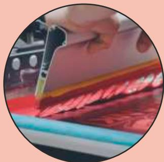
A **IMPRESSÃO SERIGRÁFICA**, também conhecido como silk-screen ou impressão a tela, é um processo de impressão à base de estêncil na qual a tinta é forçada através de um crivo fino para o substrato abaixo dela.
